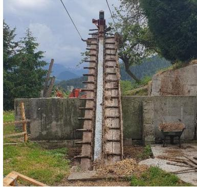
FIGURE 27: SORTIE CHAINE A FUMIER AU STOCKAGE
